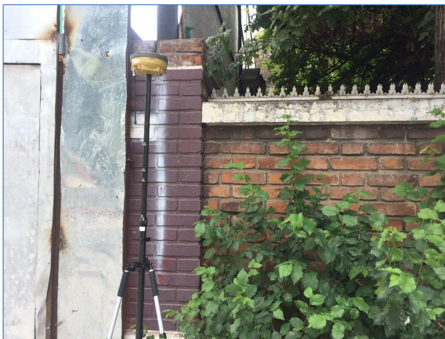
Figura 5. Levantamiento de la línea divisoria sur del lote, a un costado de la calle Asturias.
